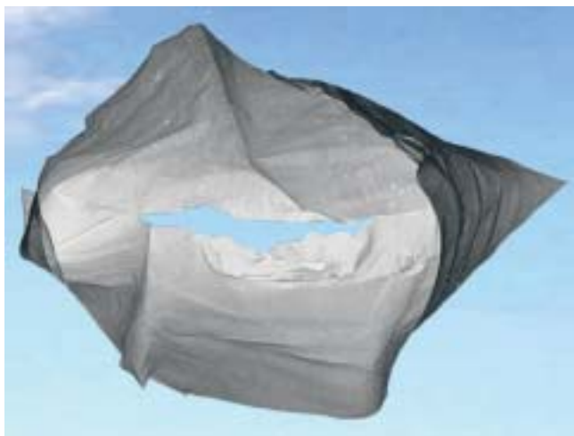
Fragment mikrorurki wykonanej metodą elektroprzędzenia nanowłókien
